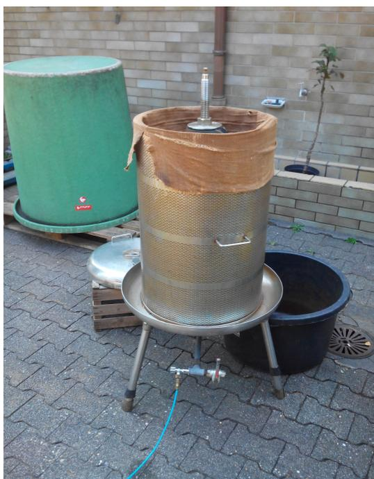
*Illustration 4: On transporte manuellement le résultat dans le pressoir. Sous l'action du ballon, les pommes sont pressées et le jus se dégage.*
